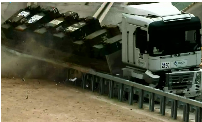
Bild 5: SUPER-RAIL Eco HS erreicht zusätzliche Leistungsklasse H4b/L4b-W4-VI9-B
