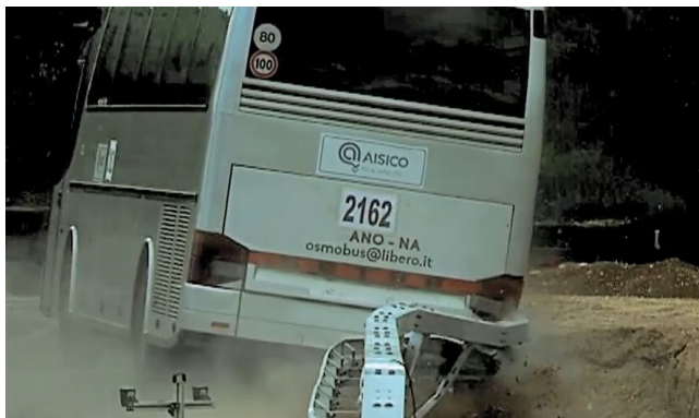
Bild 3: Einsatz der SUPER-RAIL Eco auf schmalen Bankett (1,0 m Breite) mit 2,4 m langen Pfosten wie geprüft
