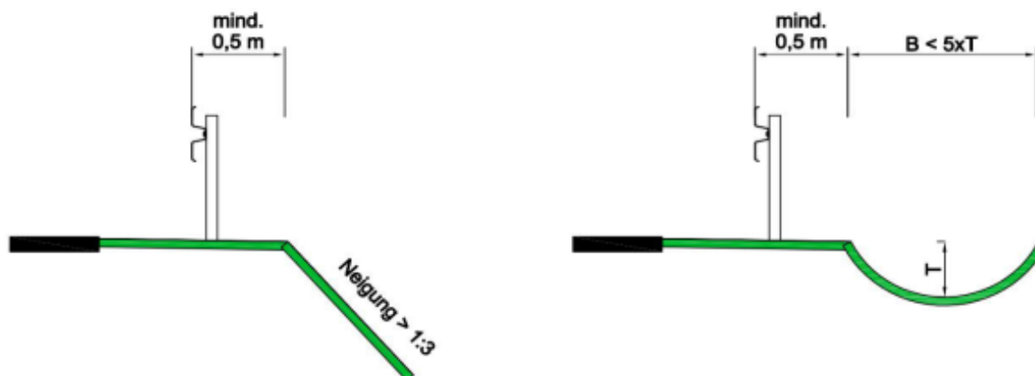
Bild 2: Einsatz der Eco-Safe auf schmalen Bankett (1,0 m Breite) wie geprüft
