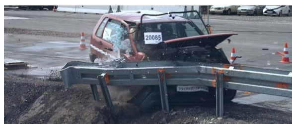
Bild 2: Fotosequenz vom TT2.1.80-Versuch an der AEK Protector
