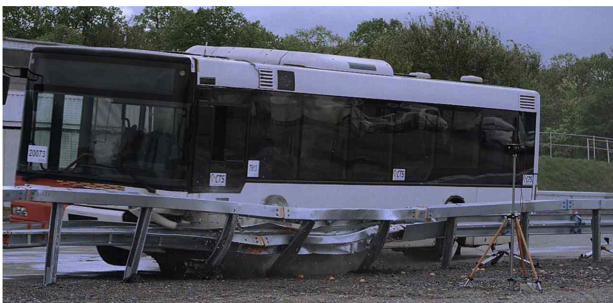
Bild 5: TB51-Anprallprüfung an der ÜK FLEXTRA SR Eco – SR HS (H2-W4-B)
