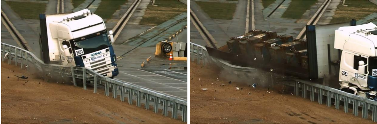
Bild 2: TB81-Anprallprüfung an FLEXTRA SR – SR Eco HS (H4b-W5-B)
