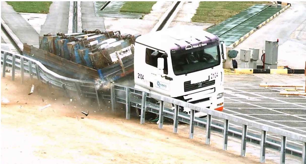
Bild 8: TB81-Anprallprüfung an FLEXTRA SR – SR HS, H4b
