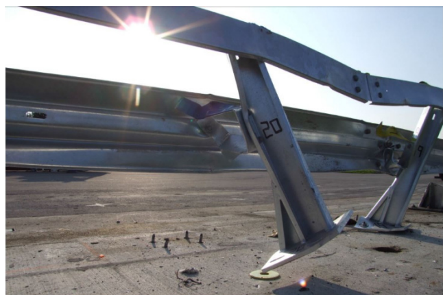
Bild 1: Unterschiedliche Verankerungscharakteristik bei Stahlschutzeinrichtungen
