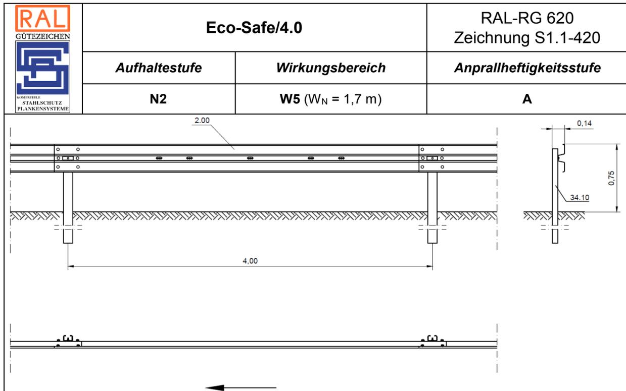
Die einseitige geramte Stahlschutteinrichtung besteht aus korrosionsgeschützt ausgeführten Bauteilen nach RAL-RG 620. Die Länge der Holme und Pfosten bestimmen das Format eines Elementes. Das System ist gekennzeichnet durch einen Pfostenabstand von 4,0 m und die an die Pfosten (Länge 1,70 m) angebrachten 4 m langen Holme. Die Schutzplankenholme überlappen und sind mit mehrfachen Schraubenverbindungen fixiert.
