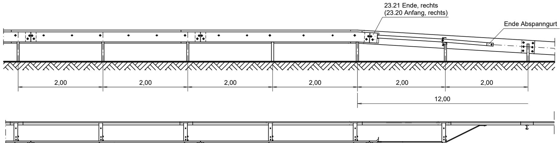
Teile Nummern, die in Klammern angegeben sind, gelten für die entsprechende Absenkung entgegen der Fahrrichtung.
