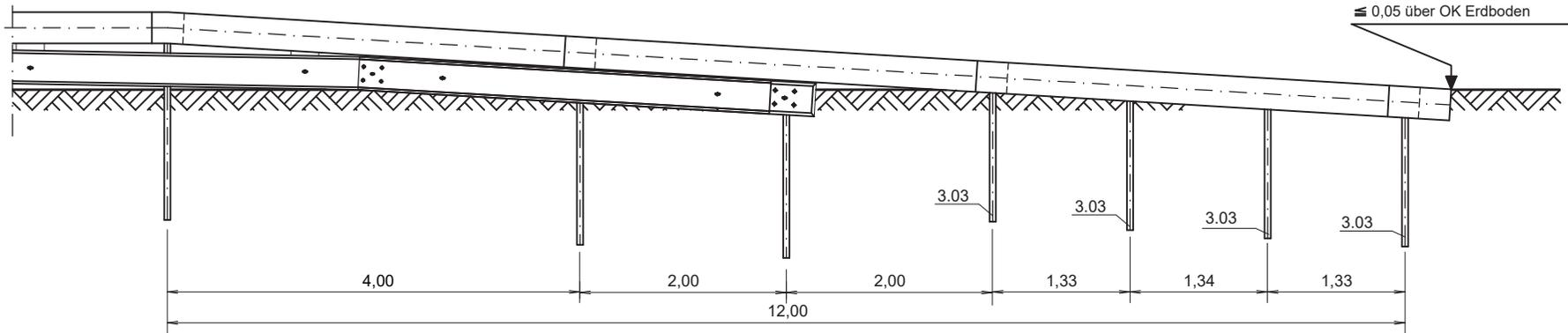
Endausbildung Unterfahrerschutz für ESP im Bereich des Übergangselements
